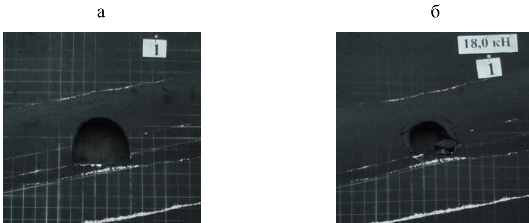
Рис. 3.2. Начало (а) и конец (б) нагружения модели (вариант 1)
