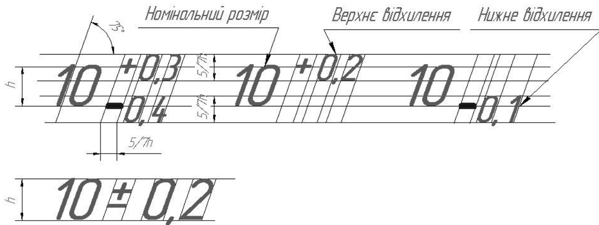
Рис. 1.15. Розташування числових значень граничних відхилень стосовно номінального розміру
