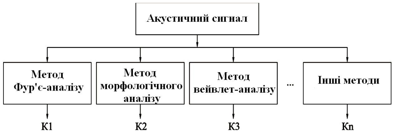
Рисунок 1.1 – Схема багатофакторного аналізу акустичного сигналу
