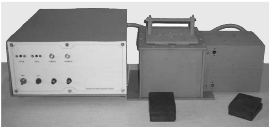
Рис. 5. Пристрій для намагнічування і повного розмагнічування магнітних блоків розміром до 115 \times 85 \times 65 \text{ мм}
