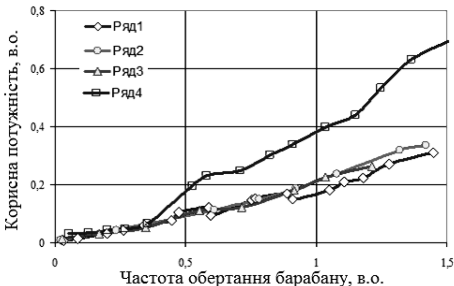
Рисунок 2.8 – Вплив частоти обертання \Psi нового типу млина із кульовим завантаженням на відносну корисну потужність p_0 при відносній частоті обертання інтенсификатора 0,142 (ряд 1); 0,284 (ряд 2); 0,426 (ряд 3) і 0,628 (ряд 4)
