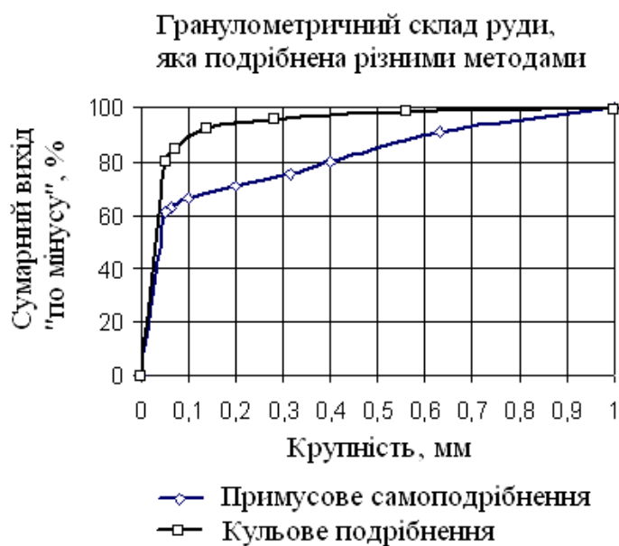
Рисунок 2.4 – Гранулометричний склад руди, подрібненої в млині примусового самоподрібнювання і кульовому млині
