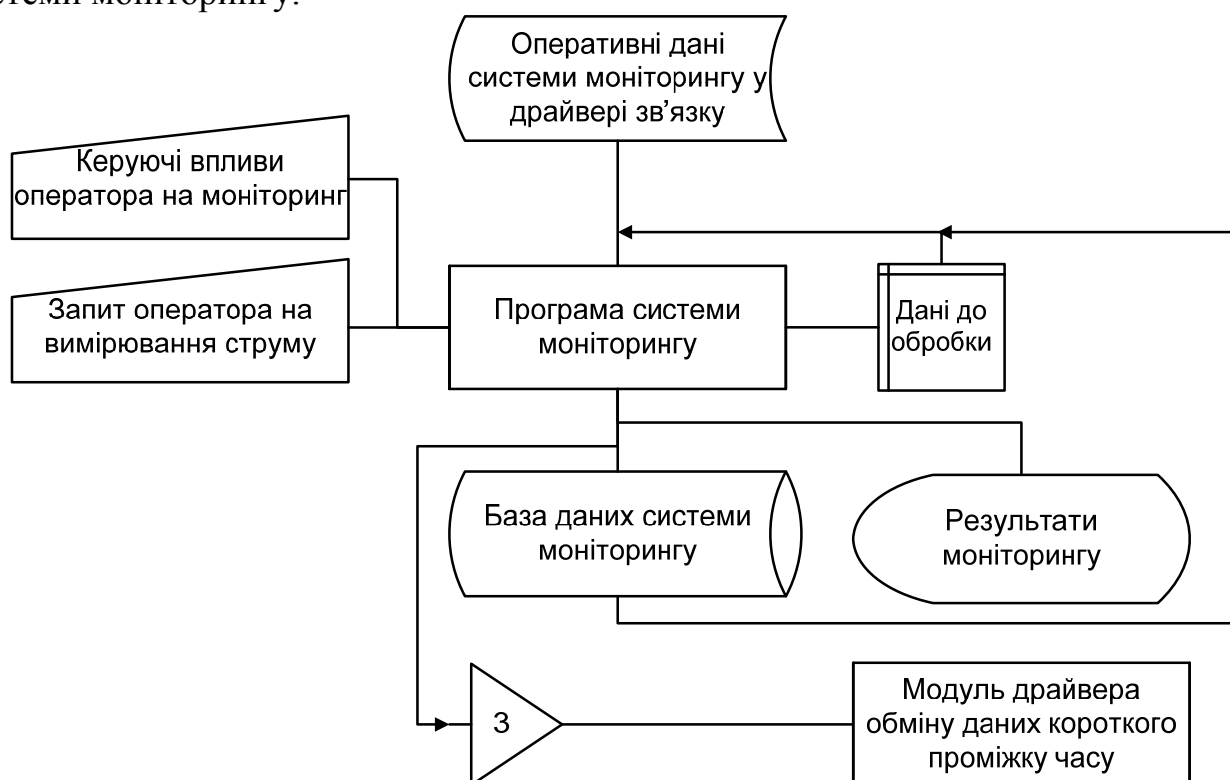
Рисунок 3.2 – Схема даних системи моніторингу. Загальне керування даними програмою системи моніторингу
