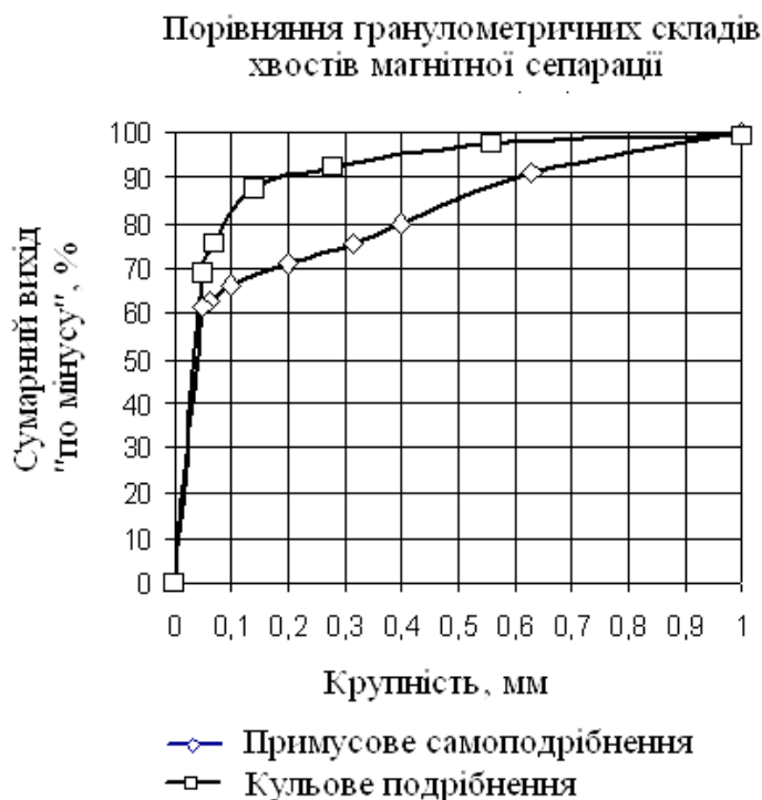
Рисунок 2.5 – Гранулометричний склад хвостів магнітної сепарації продуктів примусового самоподрібнювання і кульового
