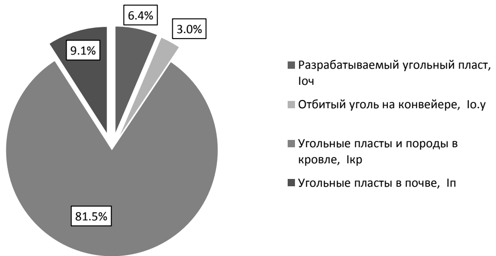
Рисунок 1. Диаграмма газового баланса выемочного участка при нагрузке на забой 2500 т/сут
