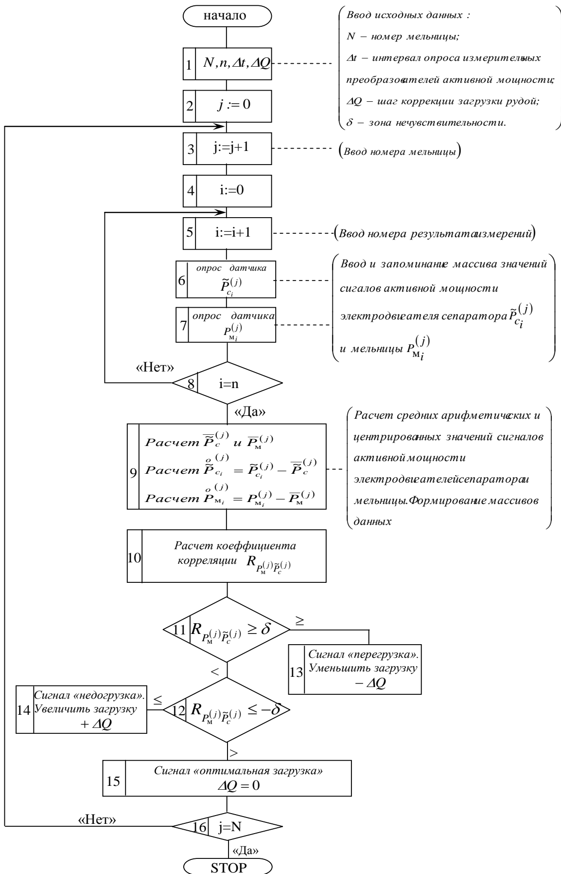
Рис. 4.6. Схема алгоритма автоматического контроля степени загрузки рудой шаровых мельниц
