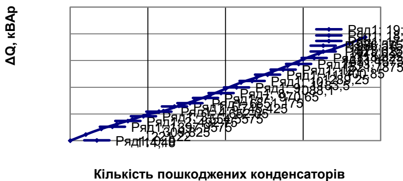
Рис. 5. Залежність втрат реактивної потужності від пошкоджених конденсаторів
