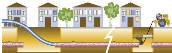
Рис. 2. Метод «труба в трубі»
