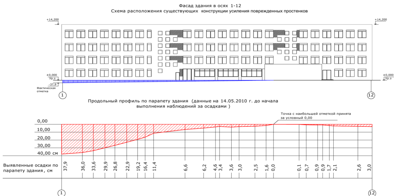
Рис. 2. Схема расположения деформаций и результаты замеров осадки фундамента здания по оси А
