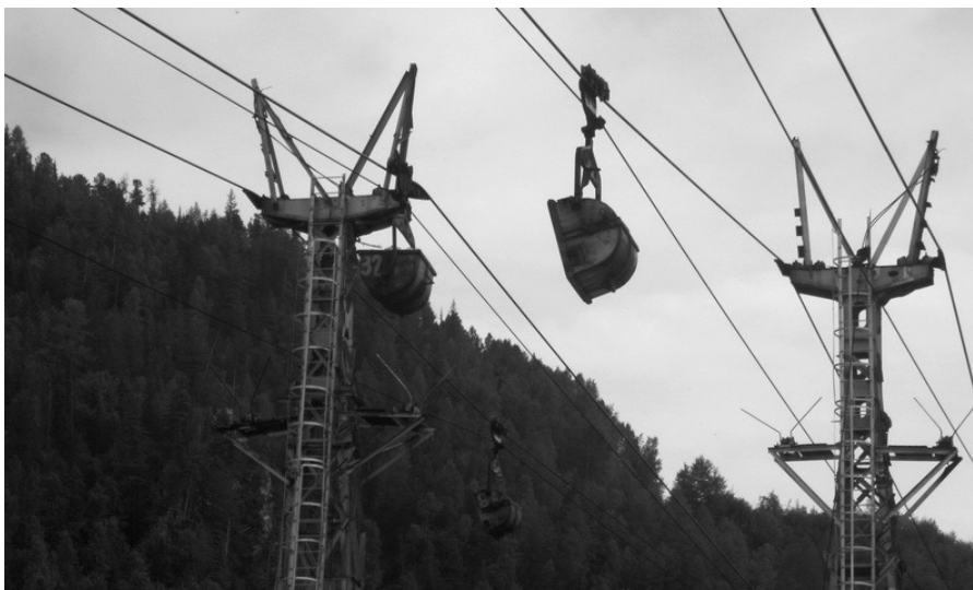
Рис. 7.2. Вантажна підвісна канатна дорога для транспортування вапняку на кар'єрі «Перевал» (Росія)
