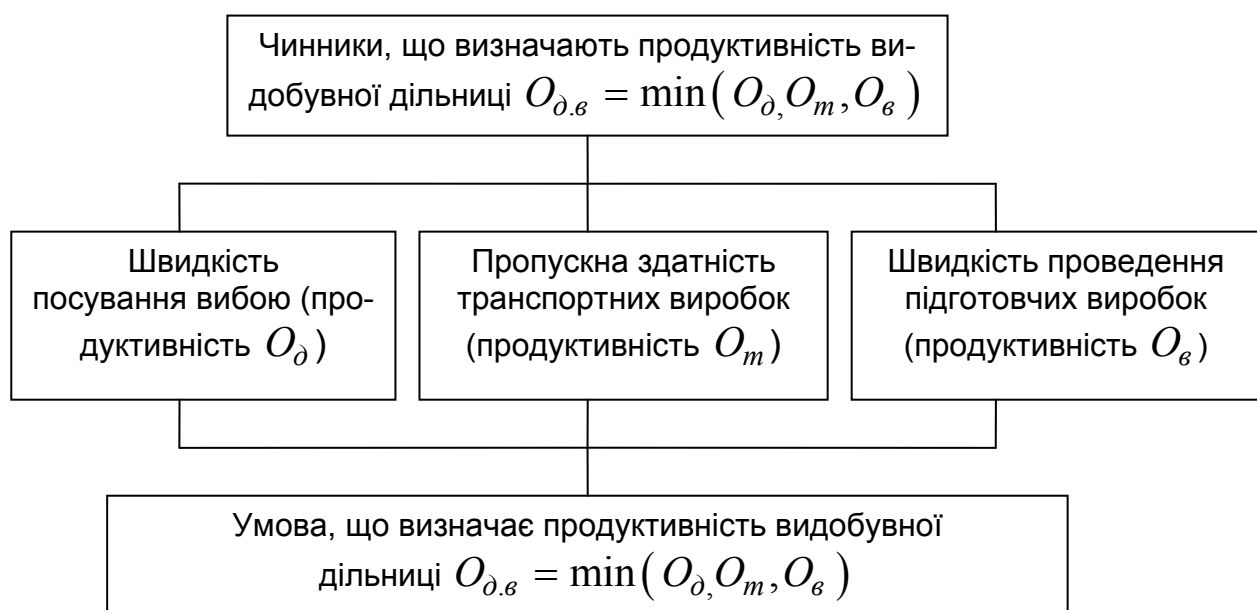
Рис. 3.3. Схема визначення напрямів управління середовищем видобувних робіт на вугільній шахті
