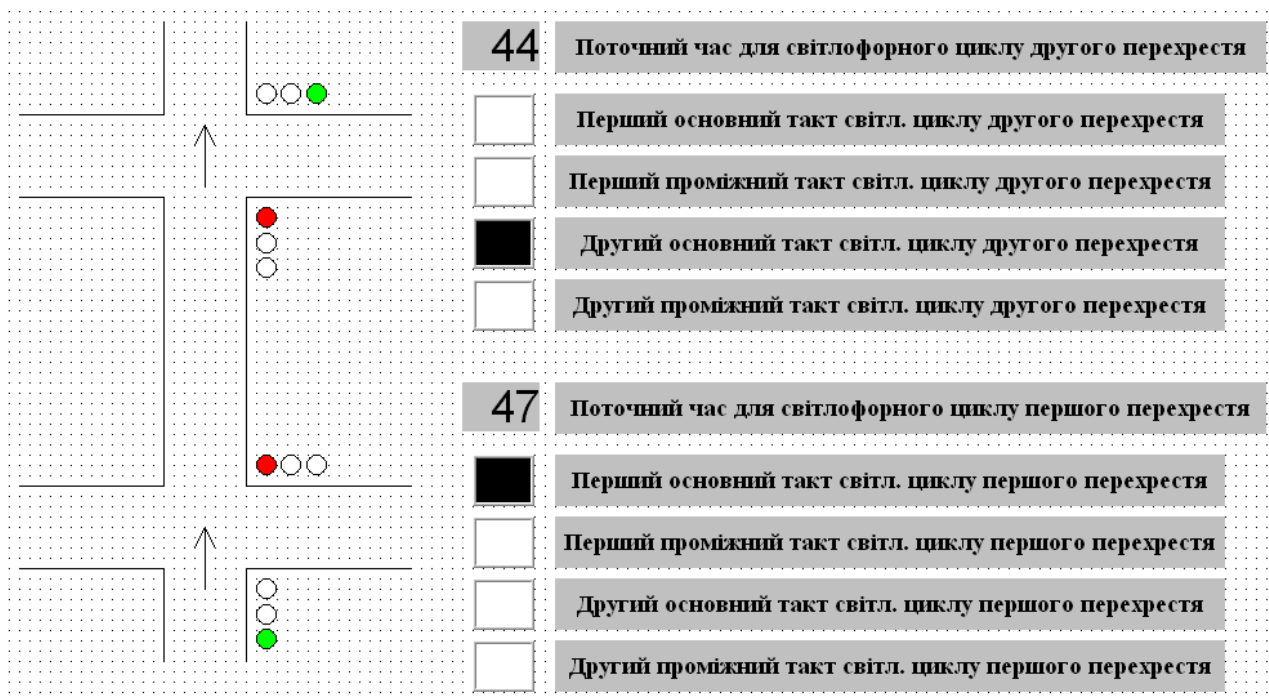
Рис.3.14. Людино-машинний інтерфейс у вигляді спрощеної схеми перехресть із розміщенням на ній імітаційних моделей світлофорних об'єктів, реалізований в редакторі форм програми «Genie»
