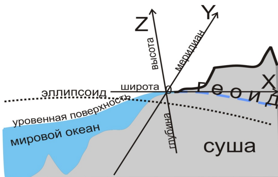
Рис. 1. Система координат, расположенная на поверхности геоида
