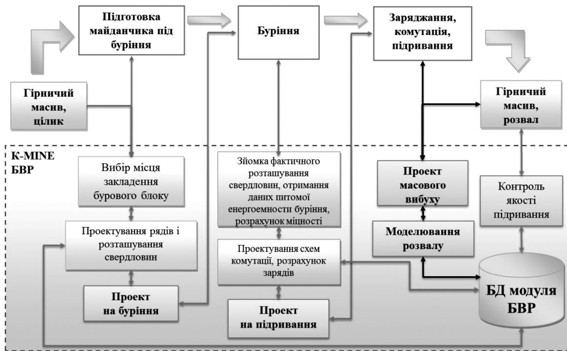
Рис. 2. Структурна схема роботи системи проектування і управління буровибуховими роботами із застосуванням K-MINE
