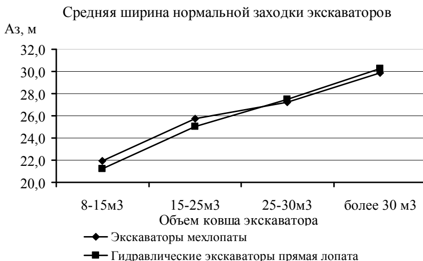
Рис. 1. Средняя ширина заходки механических и гидравлических экскаваторов типа прямая лопата
