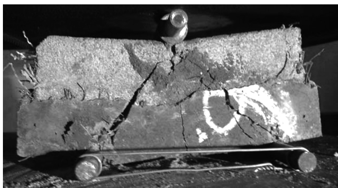
Рис. 3. Основа – фибробетон с извилистой фиброй, восстановленное покрытие – фибробетон с жесткой фиброй
