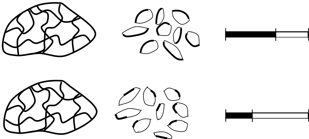
Рис. 3 – Схема, що пояснює зміну гідрофобно-гідрофільного балансу твердої фази при подрібненні із застосуванням (верхній рис.) і без застосування ефекту Ребіндера. Окиснена поверхня показана темними лініями.
