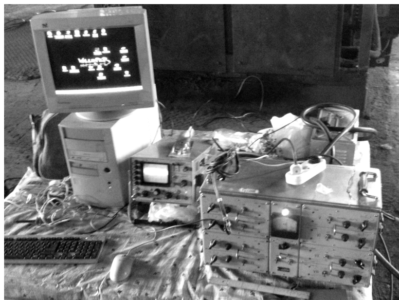
Рис. 1. Оборудование для измерения напряжений в рабочих поверхностях горных машин.
