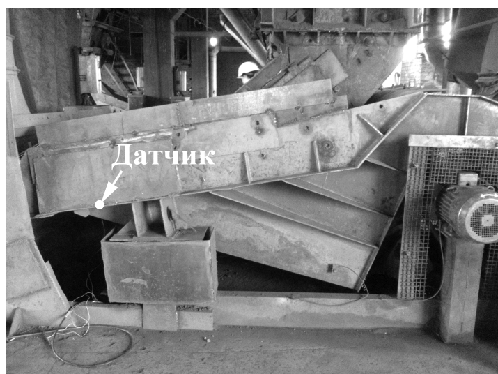
Рис. 2. Схема установка датчика напряжения на питатель инерционный ПИ-1,4
