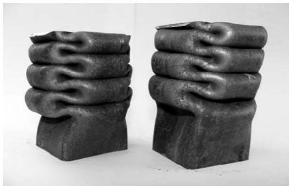
Рисунок 5 – Образцы трубы 40x40x2 после испытаний
