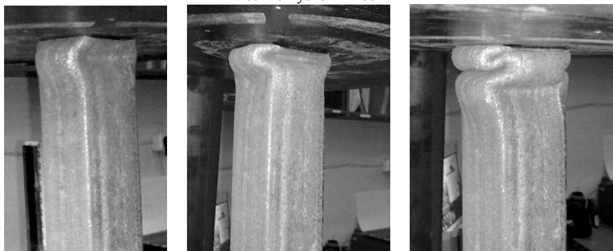
а) Рисунок 4 – Этапы потери местной устойчивости квадратной трубы б) в)
