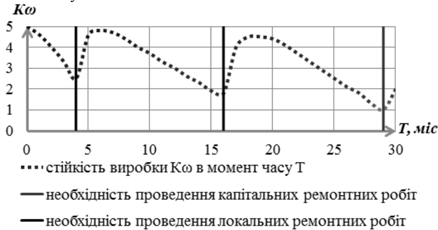
Рис. 3. Характер зміни показника стійкості виробки в часі
