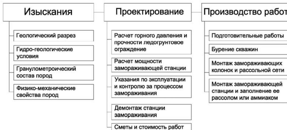
Рис. 1.3. Блок-схема основных операций при применении способа искусственного замораживания.
