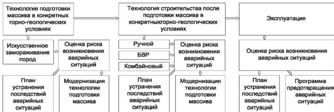
Рис.1.2.Выбор технологии подготовки массива, строительства и эксплуатации подземного сооружения при строительстве вертикальных шахтных стволов способом искусственного замораживания.
