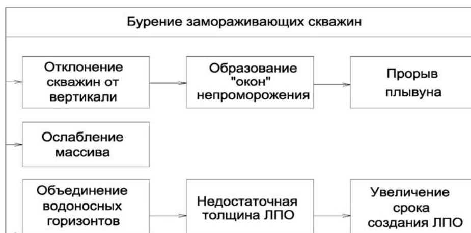
Рис.1.4. Аварийные ситуации, возникающие в процессе бурения замораживающих скважин.
