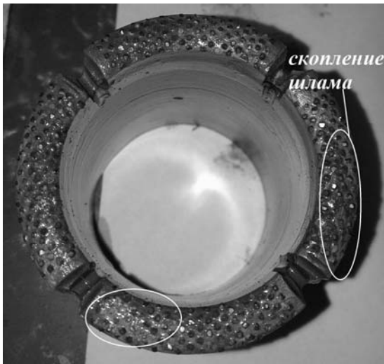
Рис. 4. Скопление шлама на сбегавшей части сектора коронки
