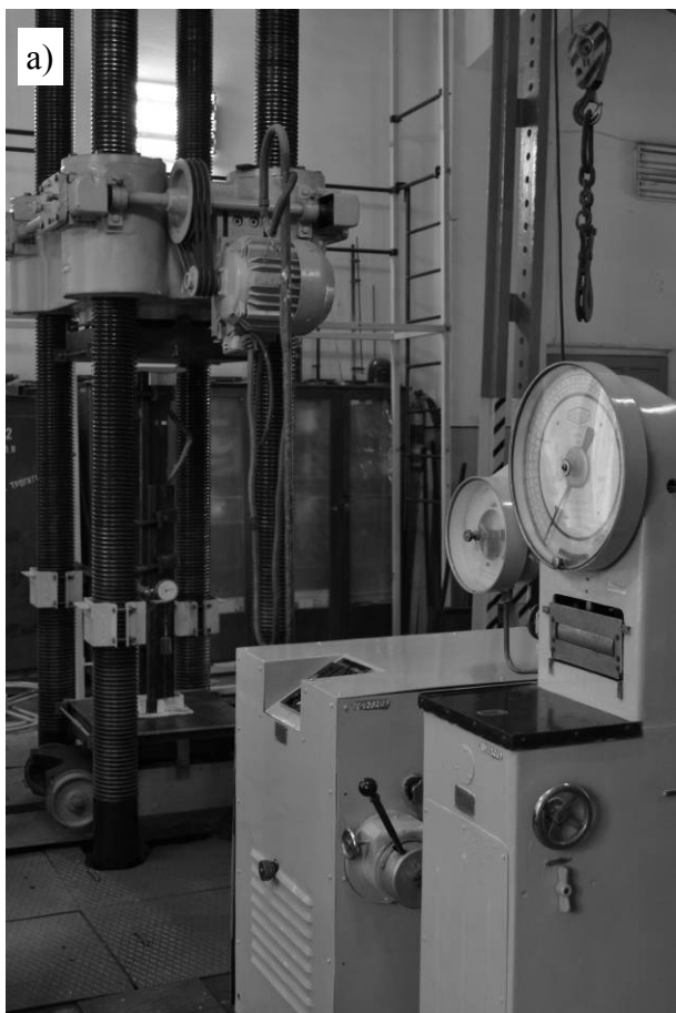
Рис. 3. Общий вид пресса ИПС-500 (а) и установленный на нем образец из СВП-33 с вкладышем из сваренных четырех полос стали 50 \times 4 мм длиной 50 см
