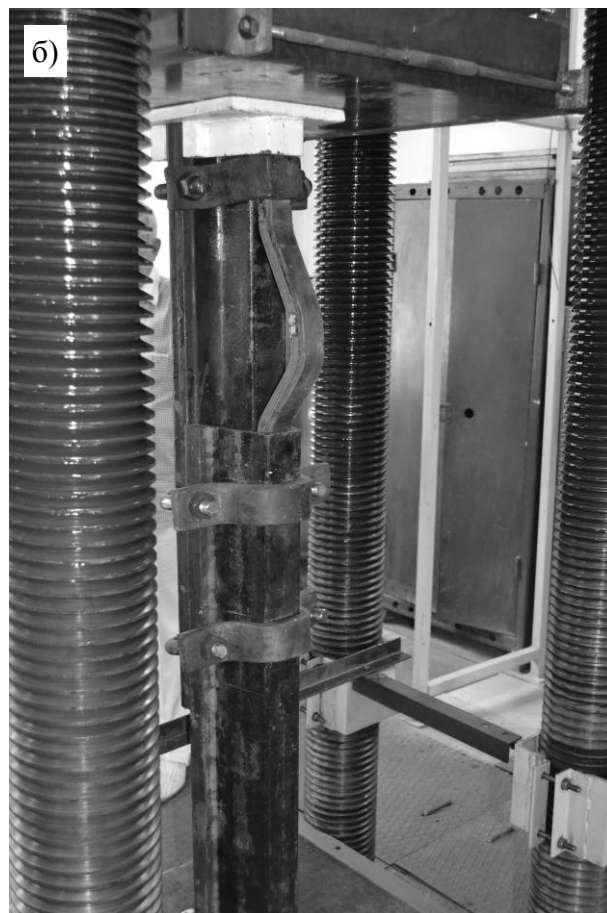
Рис. 3. Общий вид пресса ИПС-500 (а) и установленный на нем образец из СВП-33 с вкладышем из сваренных четырех полос стали 50 \times 4 мм длиной 50 см
