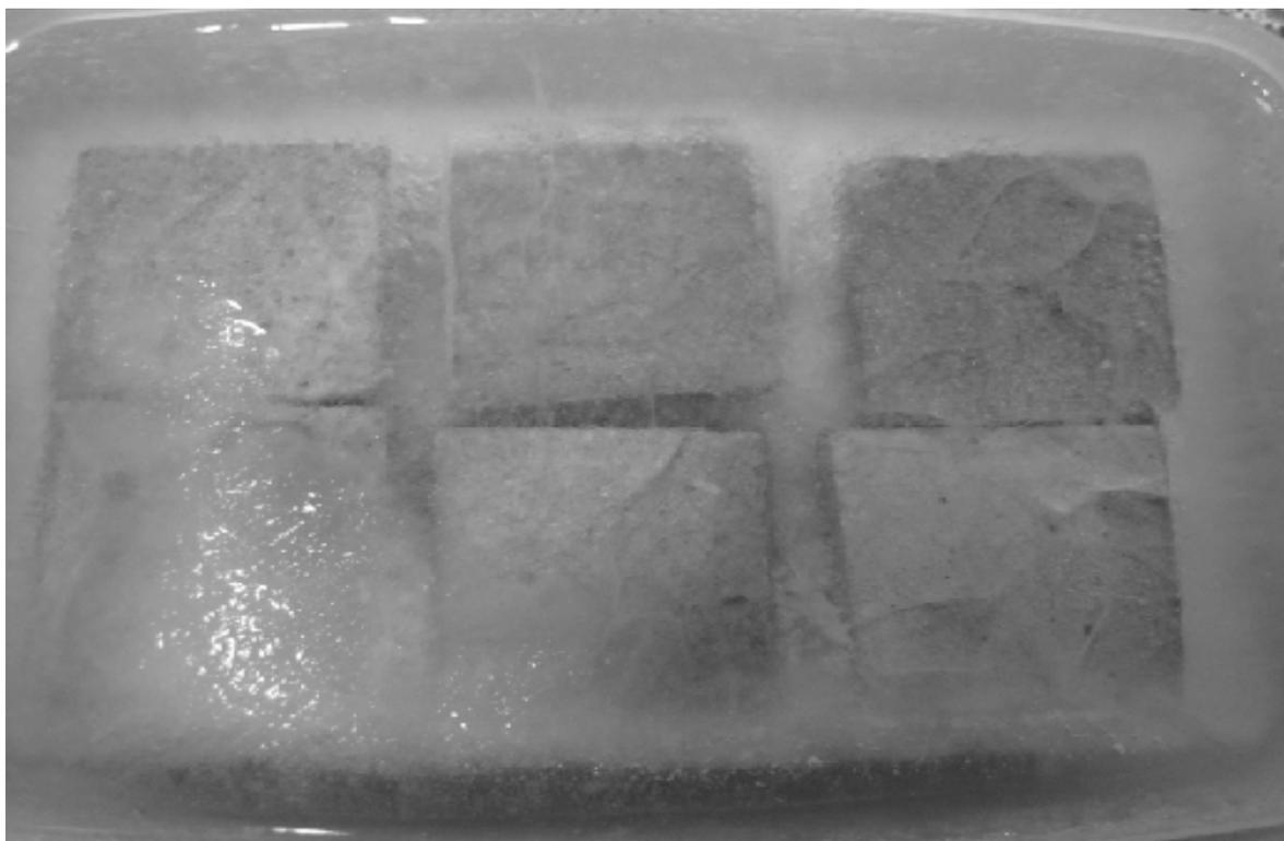
Рис. 2. Бетонные образцы в мерзлом состоянии (первый цикл замораживания).
