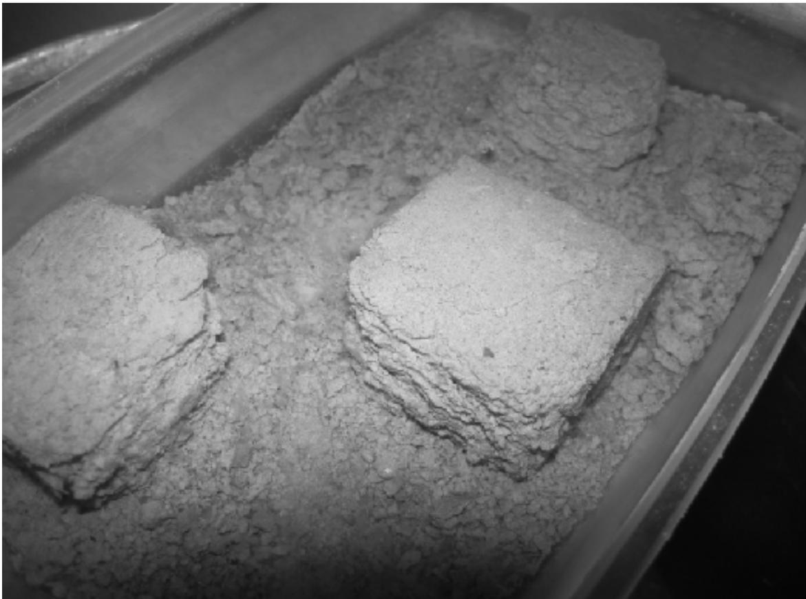
Рис. 6. Бетонные образцы. Двадцать первый цикл замораживания – оттаивания.
