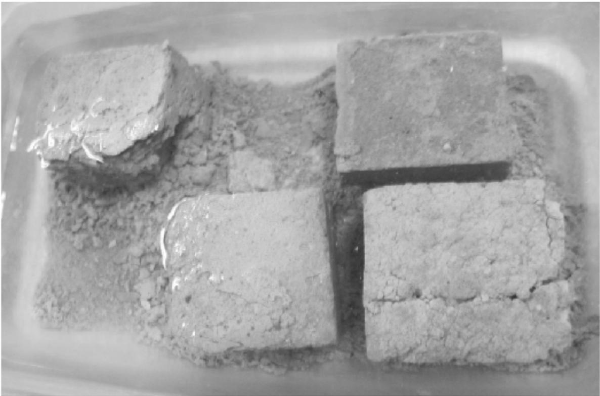
Рис. 5. Бетонные образцы. Пятнадцатый цикл замораживания - оттаивания.
