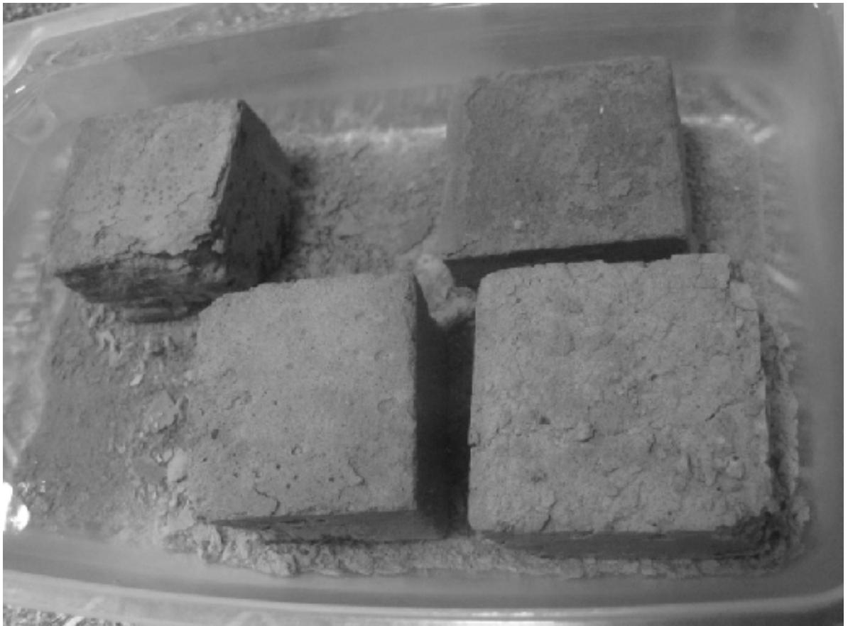
Рис. 4. Бетонные образцы. Двенадцатый цикл замораживания – оттаивания.
