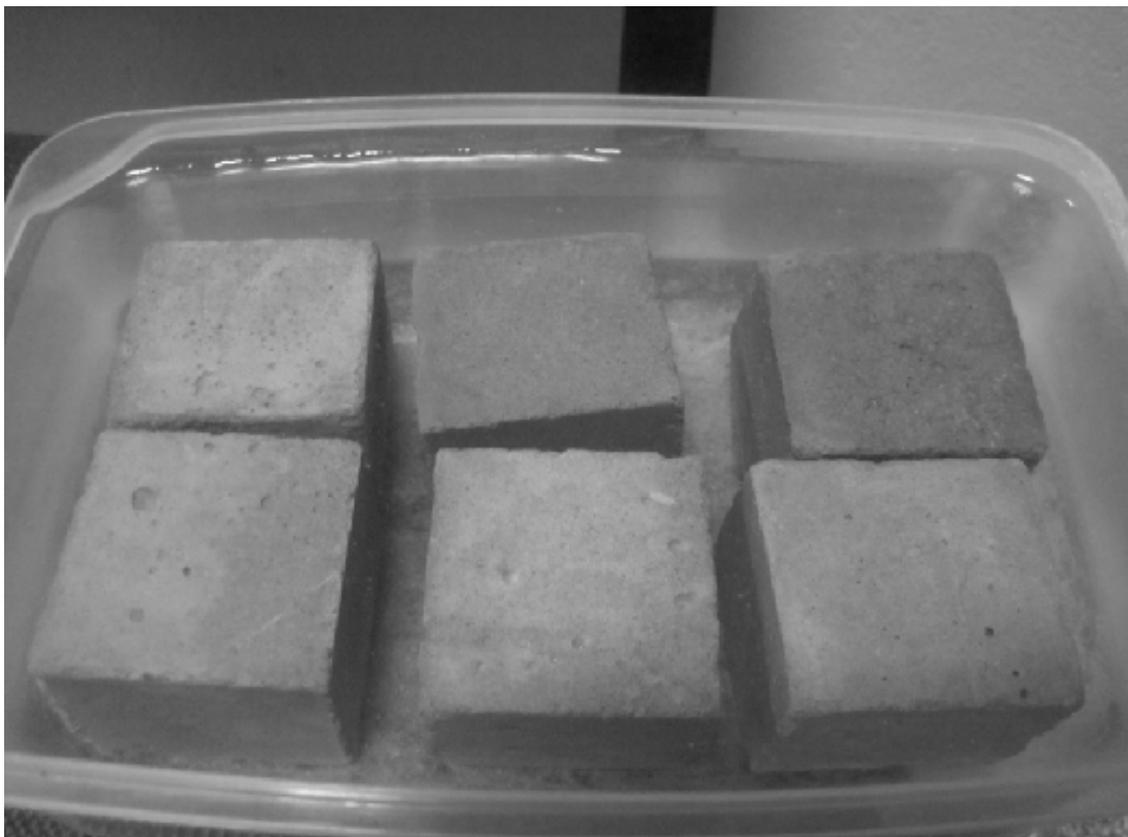
Рис. 1. Бетонные образцы. Исходное состояние (перед заморозкой)
