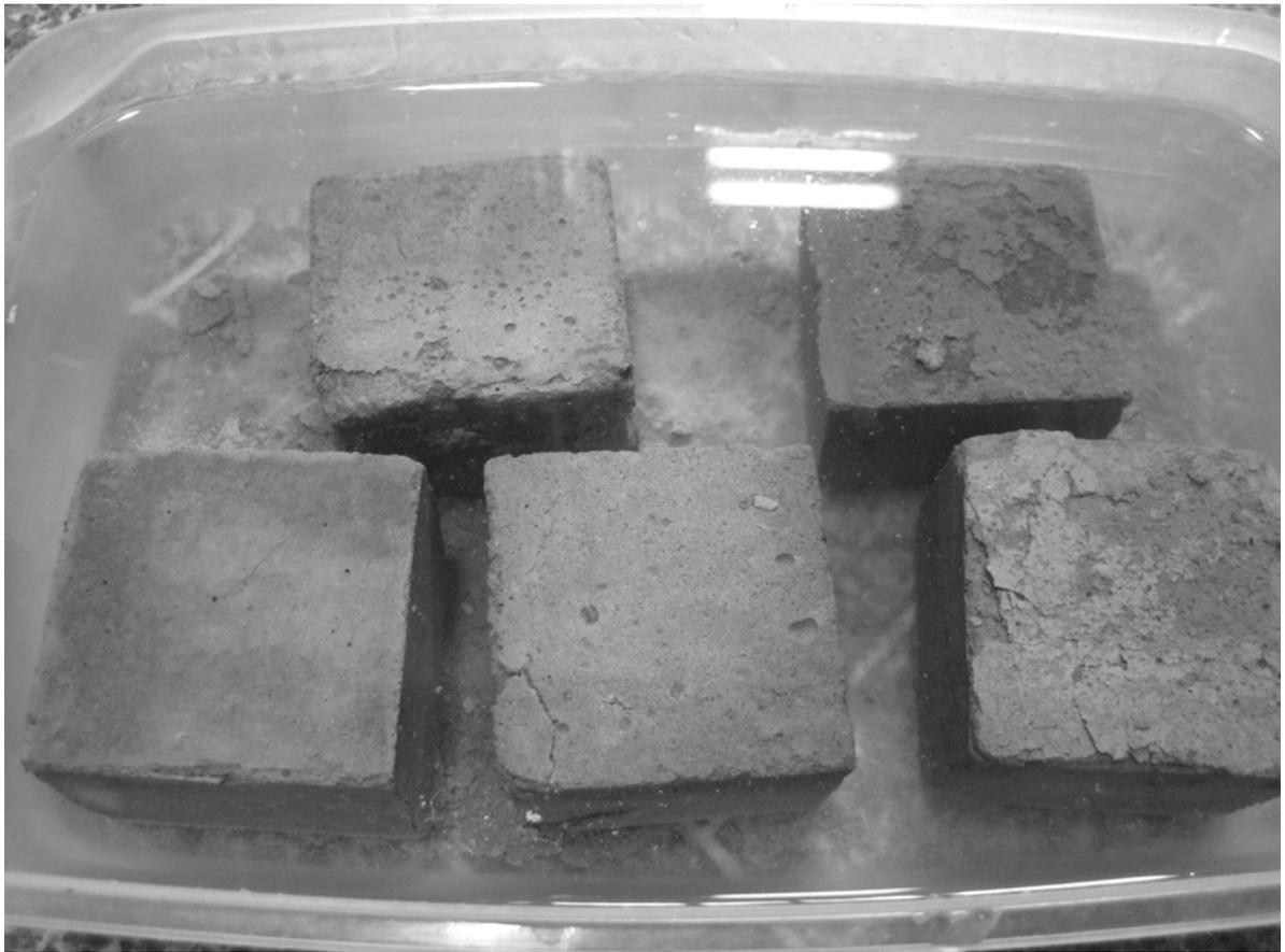
Рис. 3. Бетонные образцы. Шестой цикл замораживания – оттаивания.
