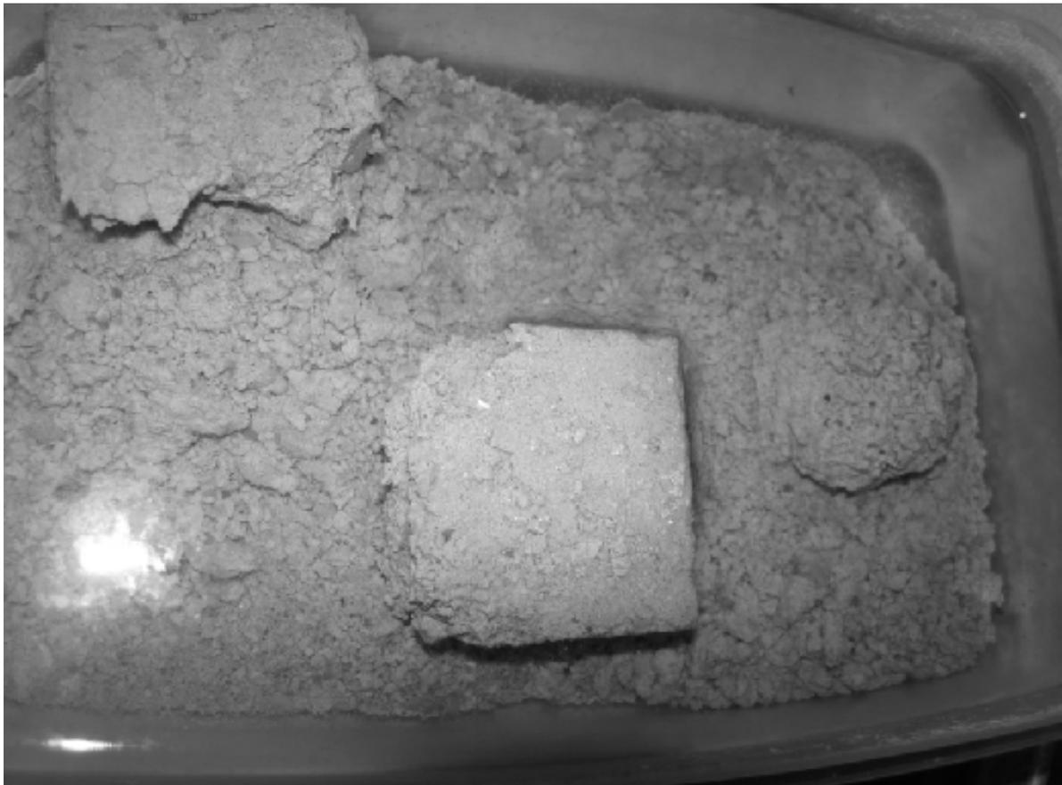
Рис. 7. Бетонные образцы. Двадцать шестой цикл замораживания - оттаивания.
