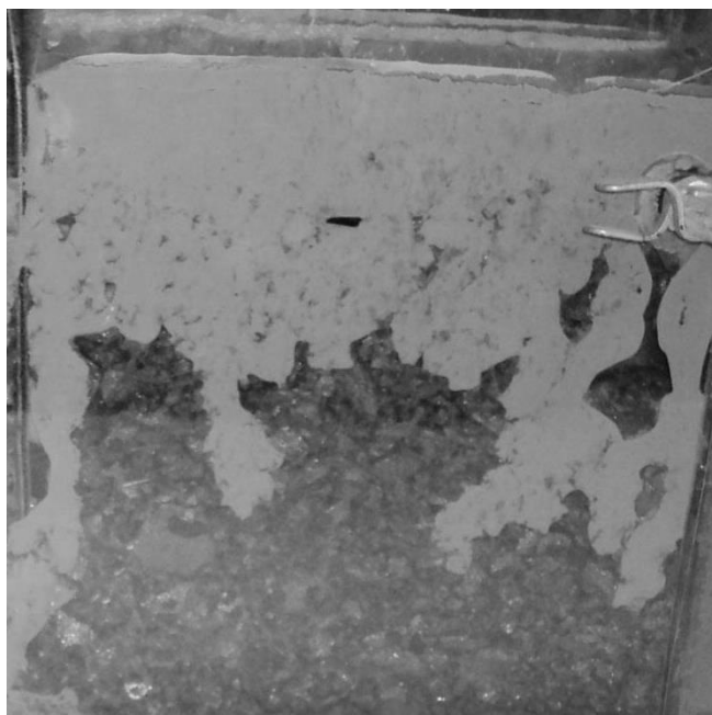
Рис. 5. Проникнення глинистого розчину в пори (модель)
