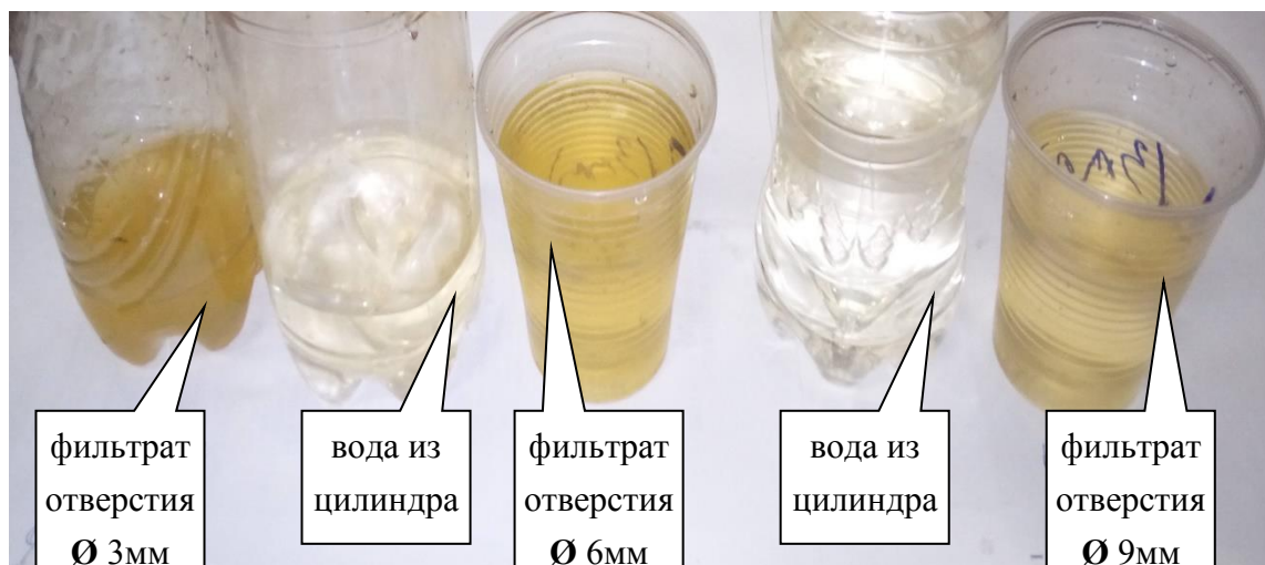
Рисунок 3 – Изменение цвета воды после фильтрации через образец
