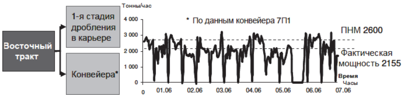
Рис. 3. Недельная почасовая производительность восточного тракта – тракт работает в среднем на 83% от максимальной мощности в силу неравномерной загрузки (источник – отчетность ЧАО «ИнГОК»)
