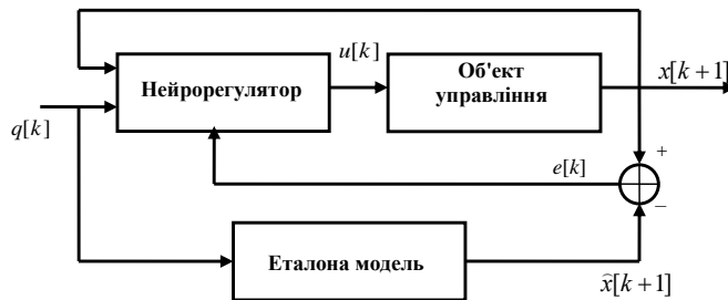
Рис.2.3. Нейромережна система управління з еталонною моделлю
