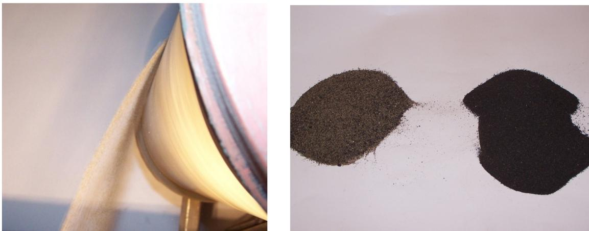
Рис. 3. Результаты фотосъемки прадуктаў раздільня сухого магнітнаго обогашчэння зерністых марганцевых шламов на сепараторе барабаннаго тыпа
