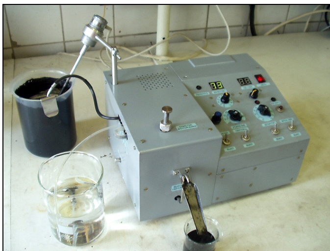
Рис. 1. Прибор для измерения эффективности процесса флокуляции "УльтрафлокТестер-2010" производства фирмы "ТУРБОФЛОТСЕРВИС"
