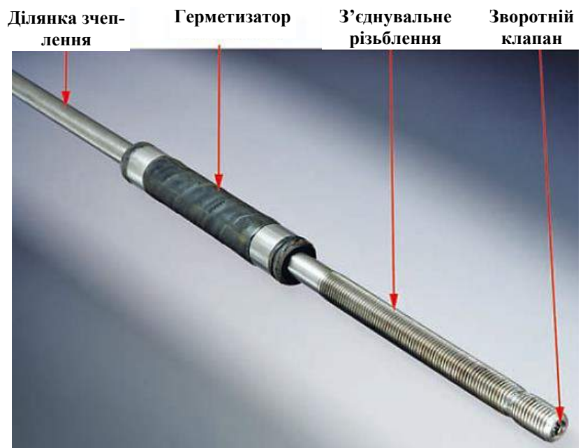
Рис. 5.47. Конструкція анкера IPMA
