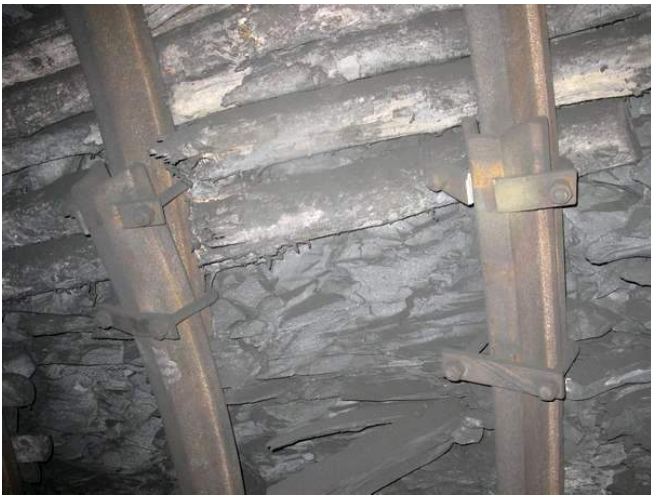
Рис. 3.16. Приклад руйнування плоских планок
