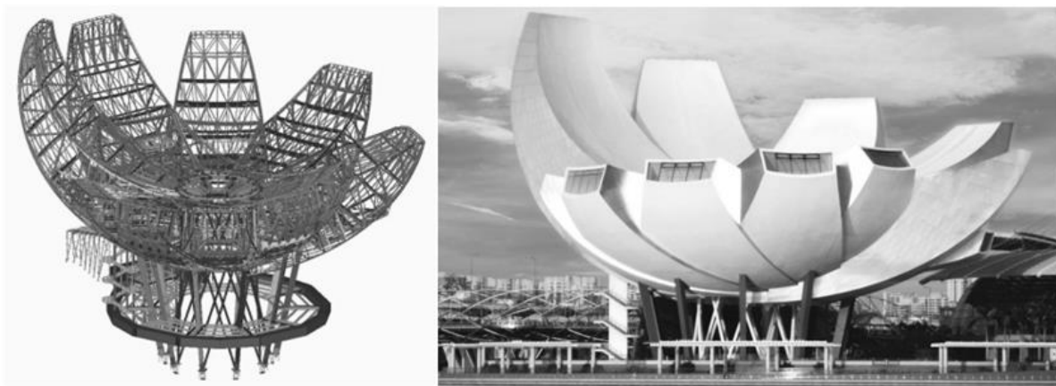
Рис. 2. Фрагмент ВІМ-моделі каркаса та реалізований проект Art Science Museum в Сингапурі, 2011 р.
