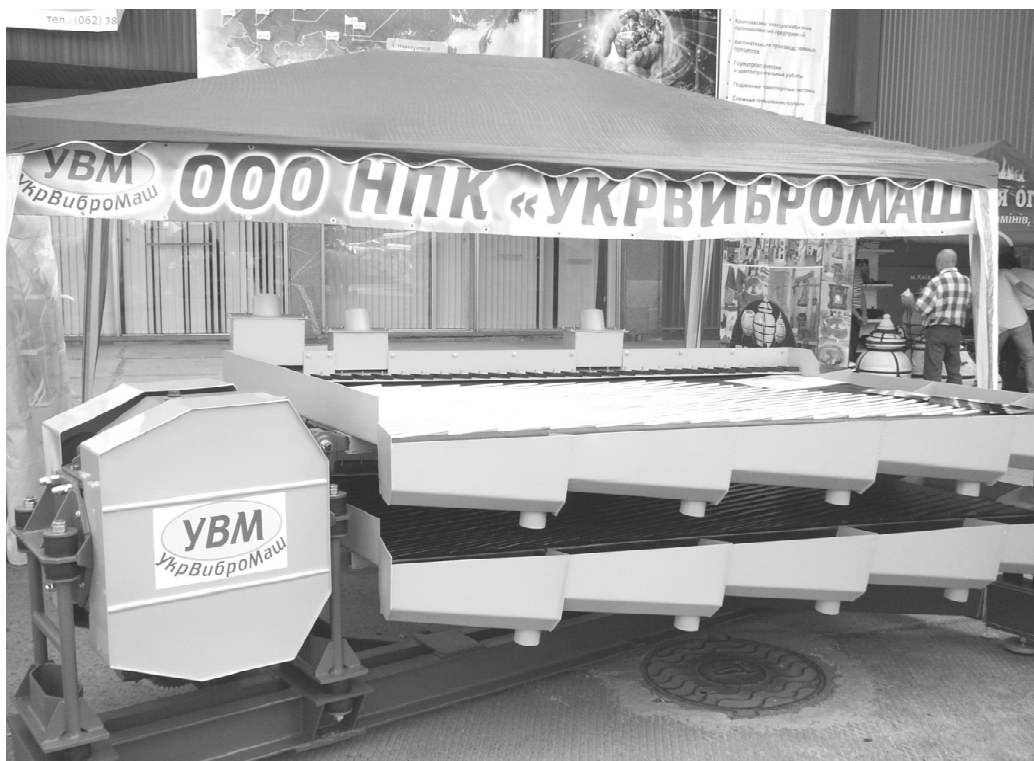
Промышленный образец концентрационного стола СКОБ-2,5×2 на Международной выставке "Уголь/Майнинг 2010"
