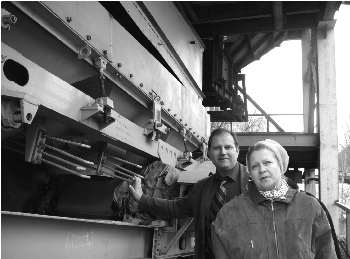
Рис. 2. Сепаратор СВП-5,5×1 в составе модульной установки пневматической сепарации
