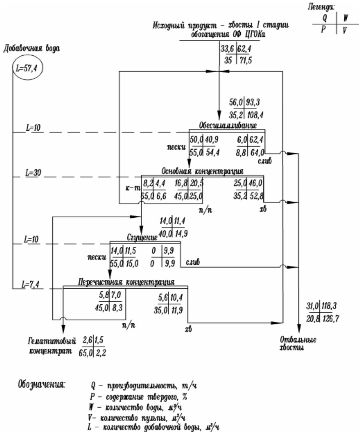
Рис. 4. Расчетная водно-шламовая схема узла получения гематитового концентрата
