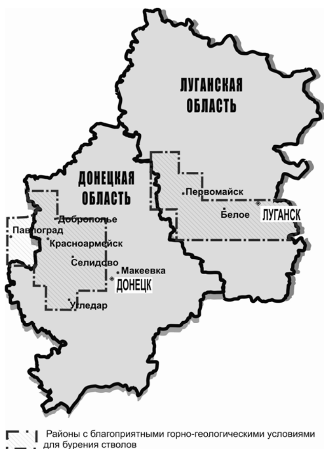
Рис.2. Карта с указанием благоприятных горно-геологических условий для проходки стволов бурением
