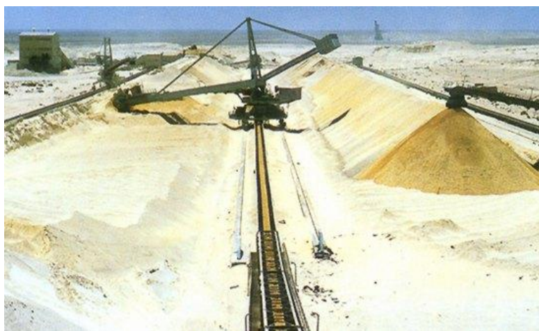
Рис. 2. Усреднение фосфоритового сырья
