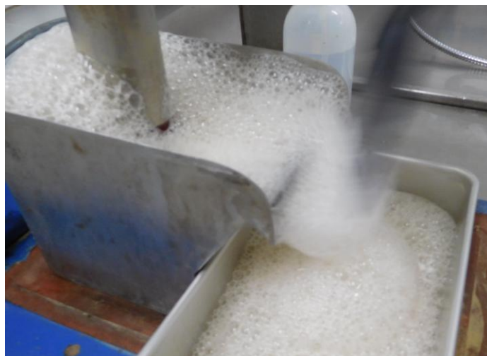
Рис. 3. Карбонатная флотация марокканских фосфатов
