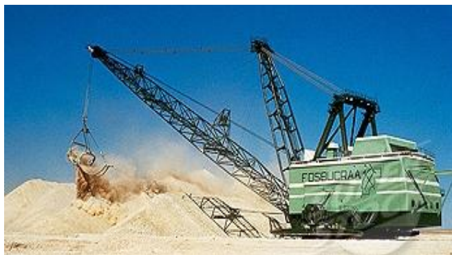
Рис. 1. Разработка вскрыши на марокканском руднике
