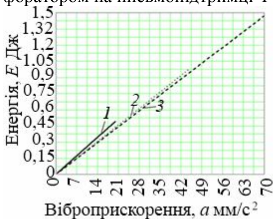
Рисунок 2 – зв'язок енергії удару E та віброприскорення a : 1 – маса ударника m = 100 г; 2 – маса ударника m = 200 г; 3 – маса ударника m = 300 г
