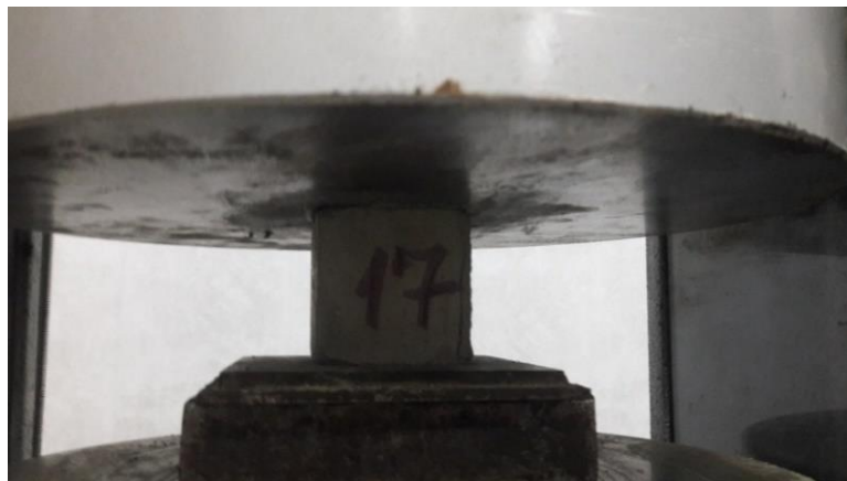
Рис. 2 Випробування зразків кубиків на пресі
