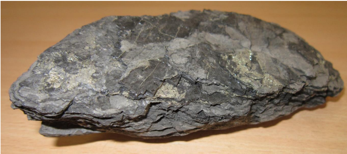
Рис. 17 Епігенетична сульфідна мінералізація у вугіллі
