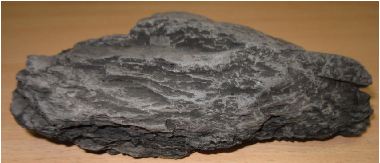
Рис. 18 Сингенетична силікатна фракція у вугіллі
