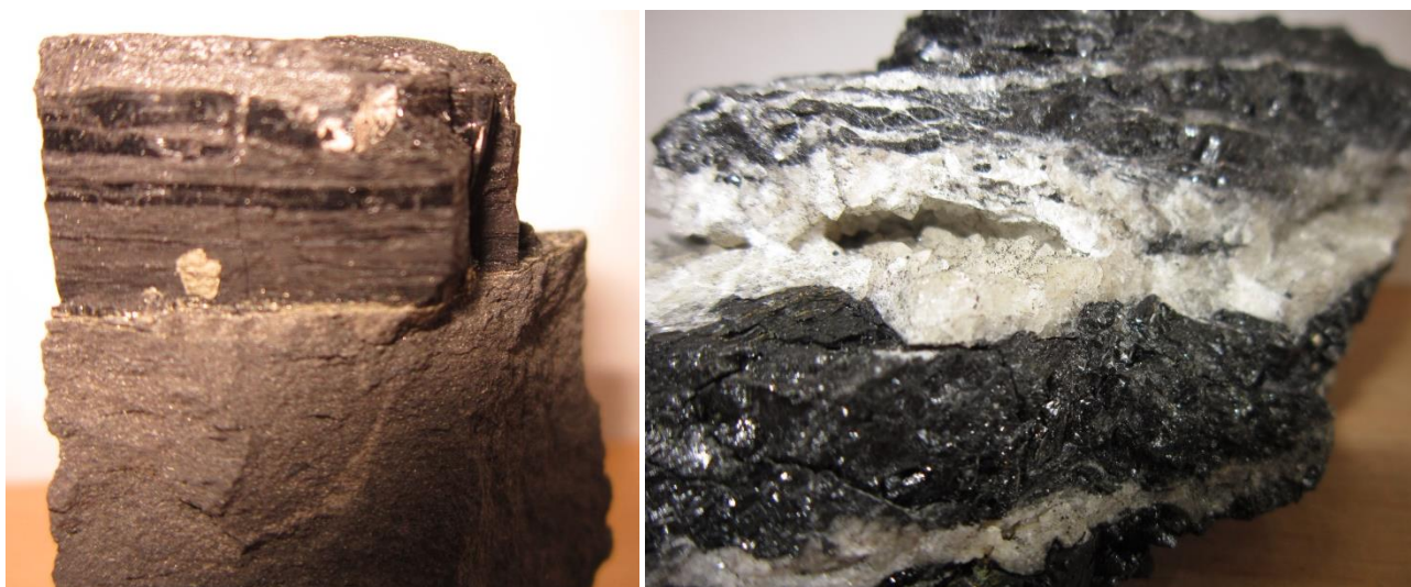
Рис. 15 Збагачення приконтаткової зони пласта сульфідами
