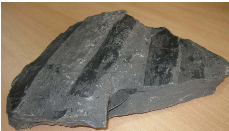
Рис. 19 Сингенетична силікатна фракція у вугіллі
