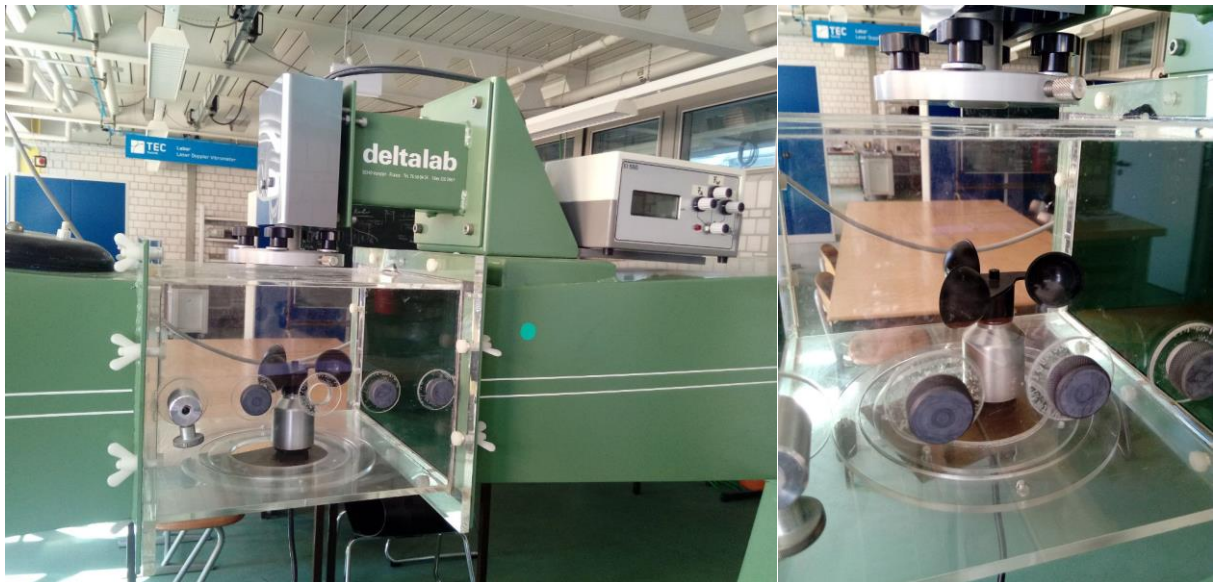
Рис 2.3 – Анемометр внутри ветрового канала
