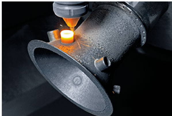
Рисунок 7 – 3D друк деталі технологією наплавлення металевго порошку
