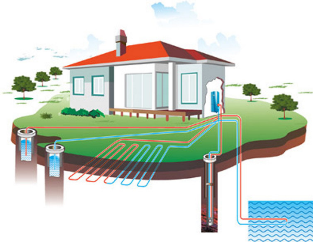
Рис. 1. Загальний вигляд різновидів геотермальних теплових насосів в цивільному будівництві
