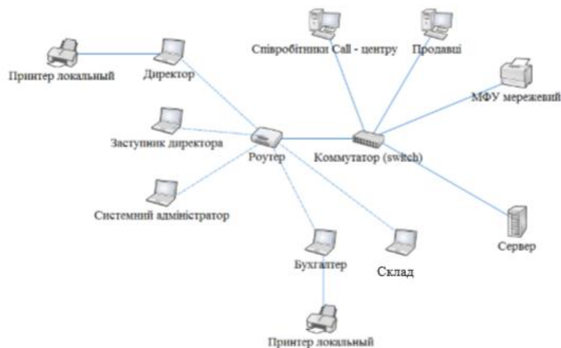
Рисунок 2.3 - Структурна схема мережі інформаційно-телекомунікаційної системи ТОВ «Авалон Днепр».
