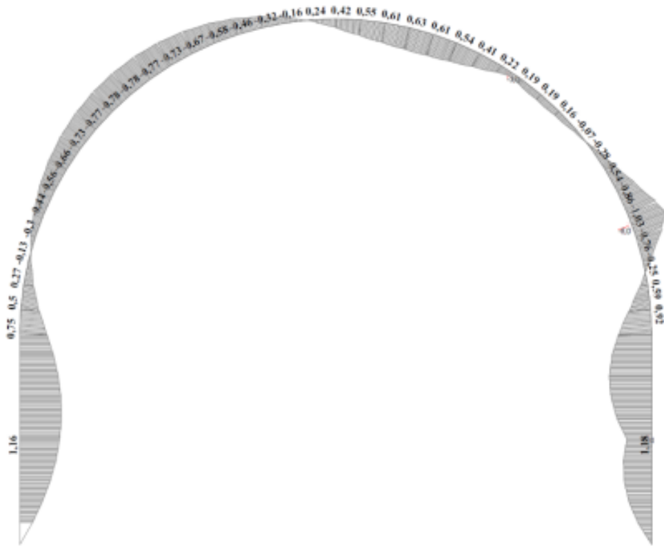
Рис 3.7. Згинальний момент від нерівномірного навантаження ( q_{\text{лів}} = 5,71 т / м, q_{\text{пр}} = 11,84 т / м) з установкою 3 анкерів з опором P1 = P3 = 3 т, P2 = 8 т.
