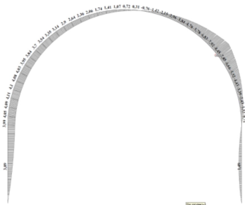
Рис. 3.4. Згинальний момент від нерівномірного навантаження ( q_{\text{лів}} = 5,71 т / м, q_{\text{пр}} = 11,84 т / м) з установкою одного анкера в точці профілю з максимальним изгибающим моментом з опором P1 = 20 т
