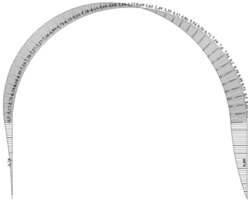
Рис. 3.2. Епюра згинальних моментів від впливу несиметричною зовнішнього навантаження при \lambda_{сім} = 2,0
