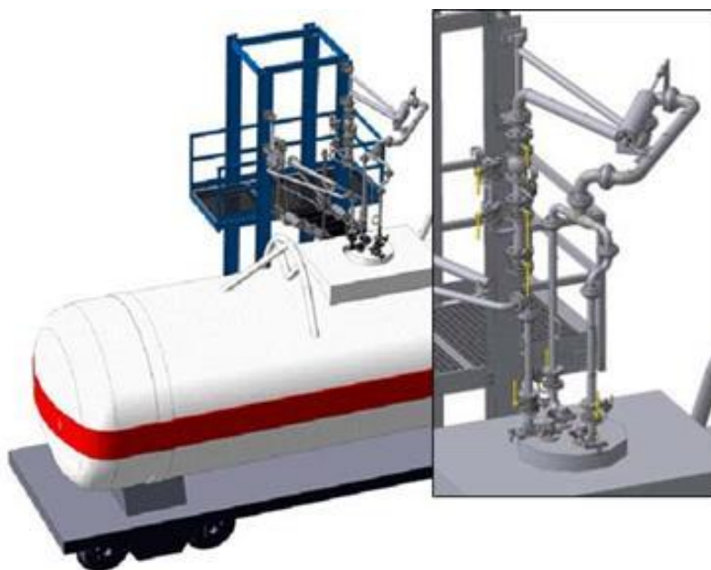
Рис. 7.5. Пристрій для зливу – наливу зрідженого газу в цистерну
