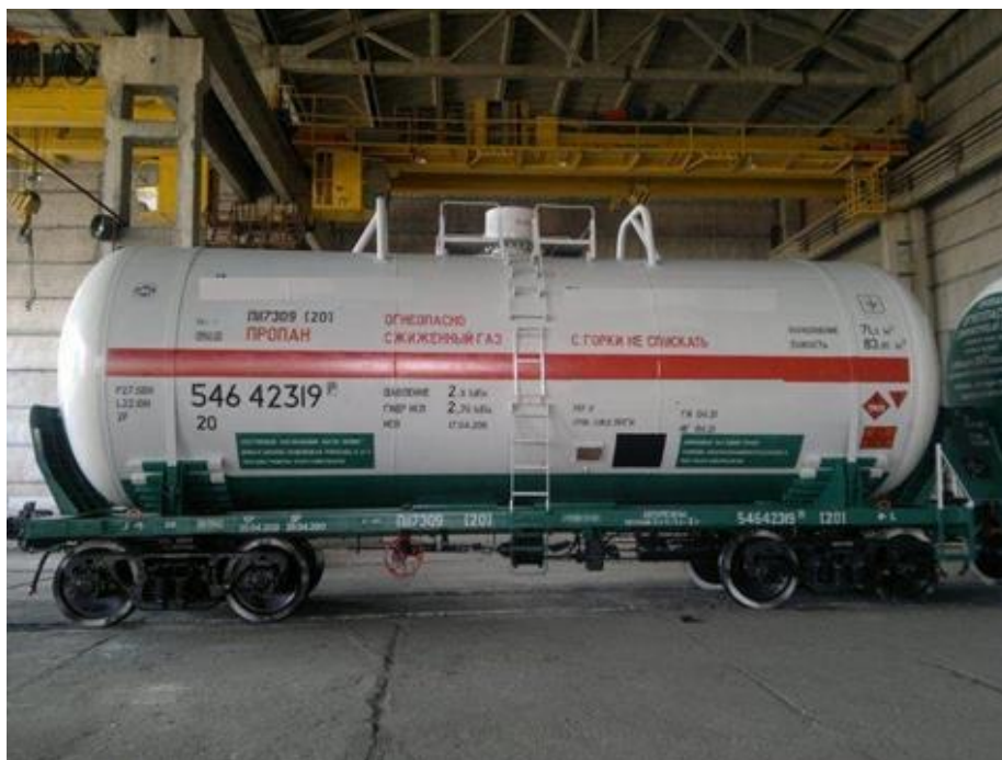
Рис. 7.1. Залізнична цистерна для зріджених газів
