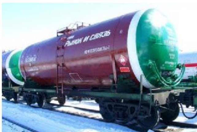
Рис. 2.13. Залізнична цистерна зі стаціонарним теплообмінником
