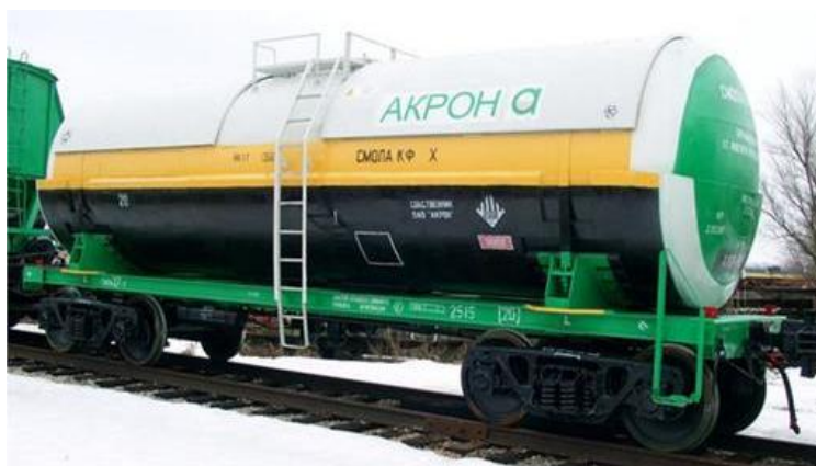
Рис. 2.12. Залізнична цистерна з паровою сорочкою
