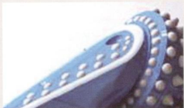
Рис. 5. Армирование козырька лапы долота.
