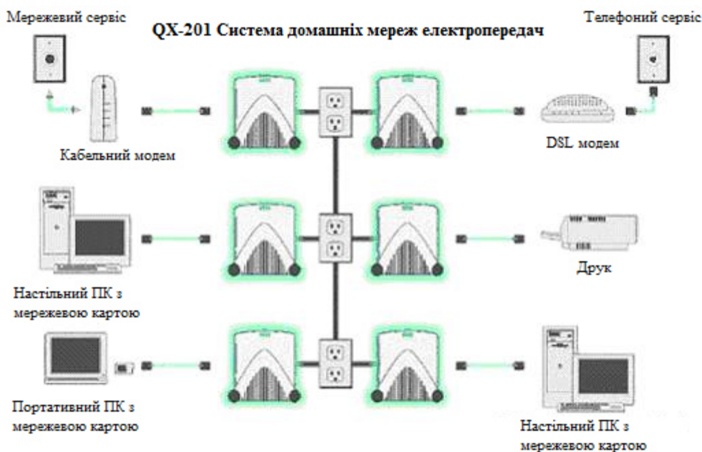
Рисунок 17.8 – Функціональна схема PLC-системи модифікації QX-201
