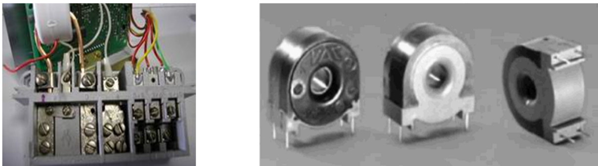
Рисунок 3.18 – Приклади приладових трансформаторів струму
