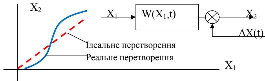
Рис. 3.11 – Схема та метрологічні характеристики перетворення сигналів
