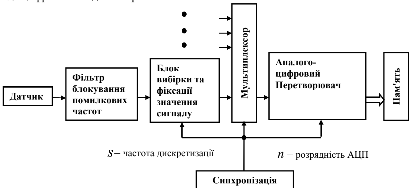
Рисунок 7.1 – Структура типової системи перетворення інформації з аналогової форми до цифрової
