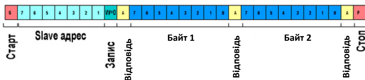
Рисунок Д1.4.7 – Передача даних від master-пристрою до slave-пристрою
