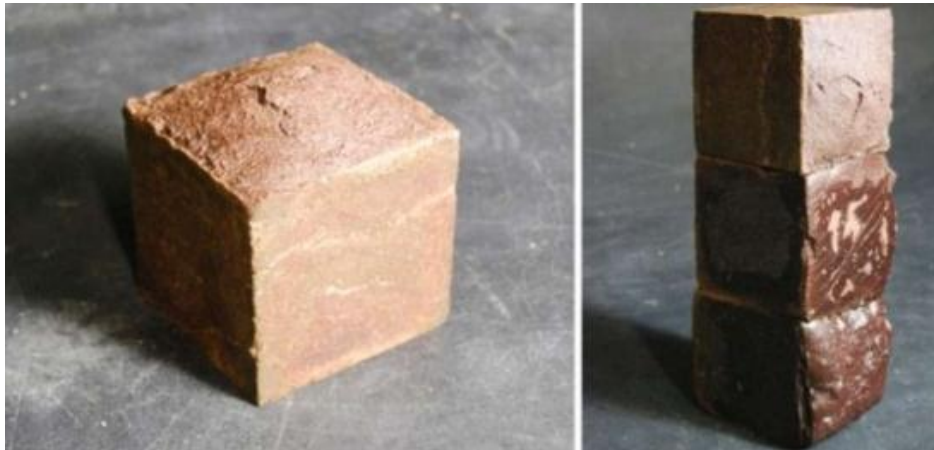
Рис. 3. Цегла з крові
